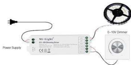
تنظیم نور خروجی چراغ با دایمر (1-10V DC )
