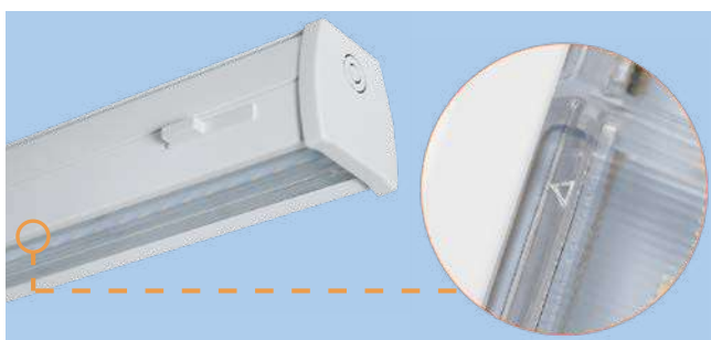
در هنگام نصب چراغ‌های مدل (M457A...) به ترانک، به علامت راهنمای نصب واقع بر روی لنز که جهت پخش نور را مشخص می‌کند توجه شود.
